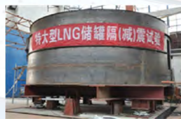
Seismic isolation test of extra-large LNG tank
